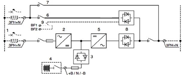
1. Separater Netzeingang für Gleichrichter und Bypass
