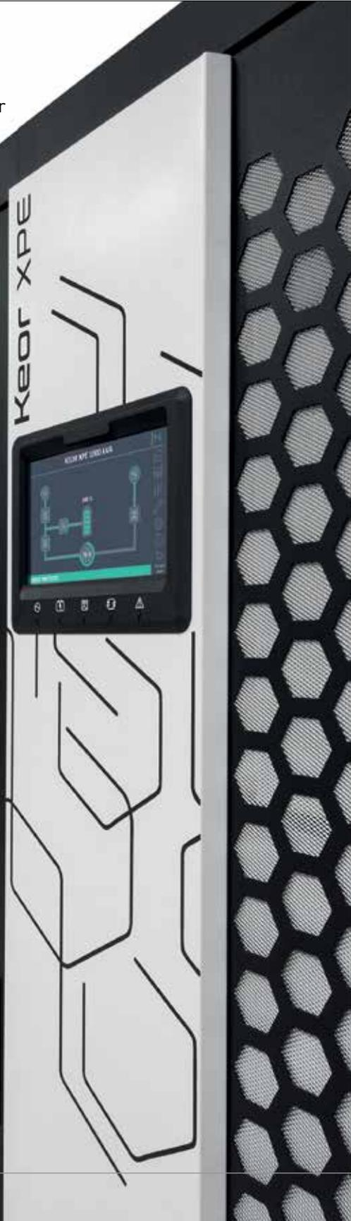
**Keor XPE** es un sistema de SAIs modular ideal para sus necesidades de suministro. Se pueden añadir hasta 7 unidades de potencia al módulo de bypass principal (IOBM), cada uno de 250 o 300 kVA
