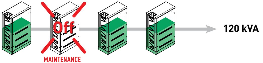
**MAXIMUM AUTOMATIC LOAD BALANCE IN CASE OF FAILURE DURING MAINTENANCE**
