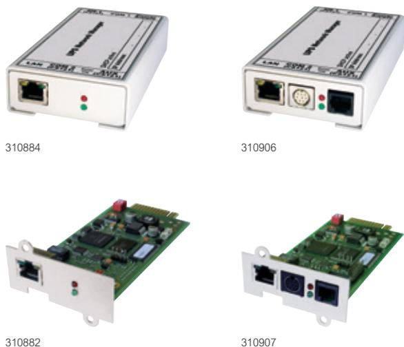
Netzwerkkarte oder Netzwerkkadaper zur Überwachung der USV-Anlage benötigen keine zusätzliche Software. Ein integrierter 32-Bit-Mikroprozessor mit einem proprietärem Betriebssystem überwacht kontinuierlich alle USV-Aktivitäten und verwaltet zahlreiche Ereignisse (Netzausfall, Überlast, Bypass, Störung, usw.) und führt folgende Aktionen aus:
