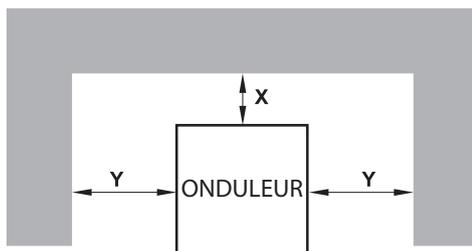
Distances minimum recommandées de l'onduleur + Armoires batteries
