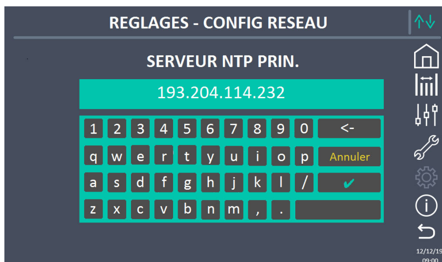
Image 31 – Modification des paramètres de l'adresse NTP
