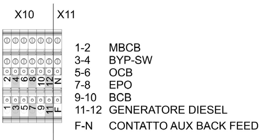
Illustration 7 – Bornes auxiliaires du KEOR HPE 400-500 kVA
