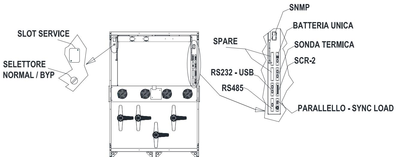
Figura 8 – Posizione schede di interfaccia KEOR HPE 400-500kVA
