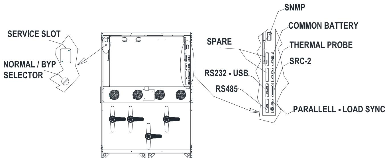
Illustration 8 – Position des interfaces de série du KEORHPE 400-500 kVA
