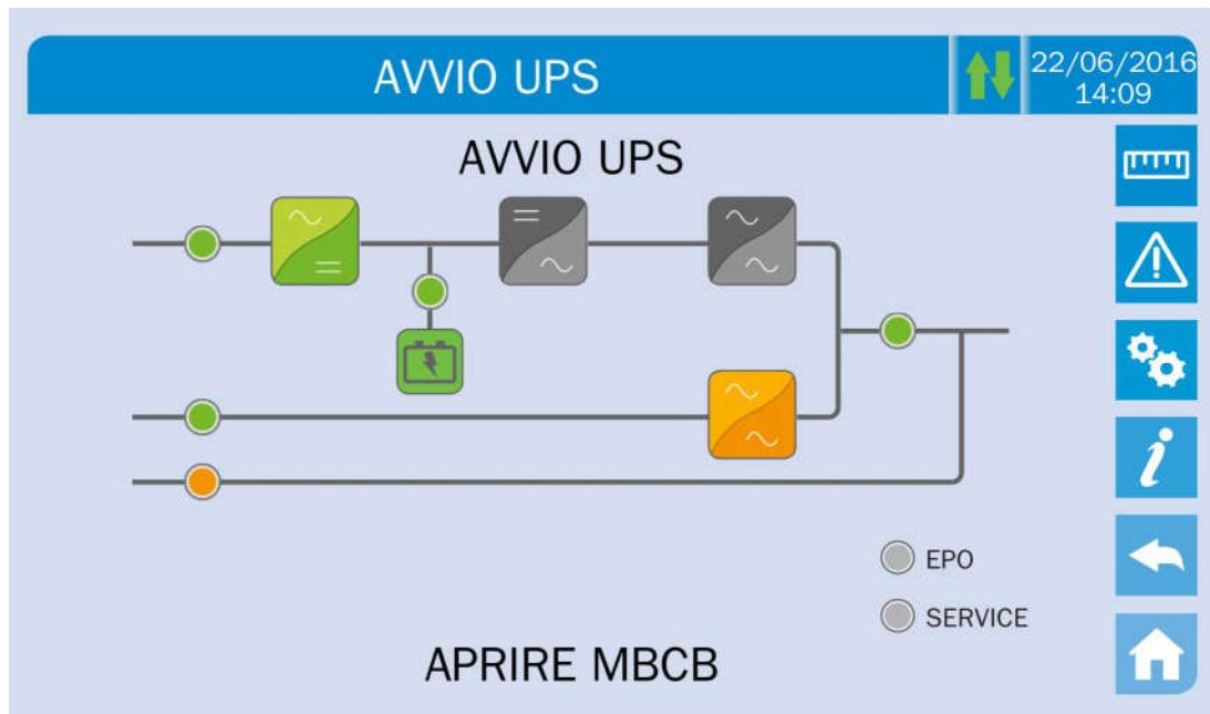
Figura 21 – Apertura del sezionatore di bypass manuale
