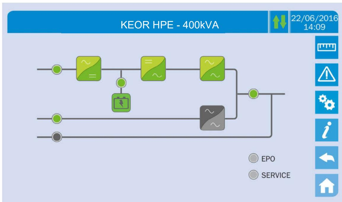
Figura 24 – Avvio da bypass manuale completato
