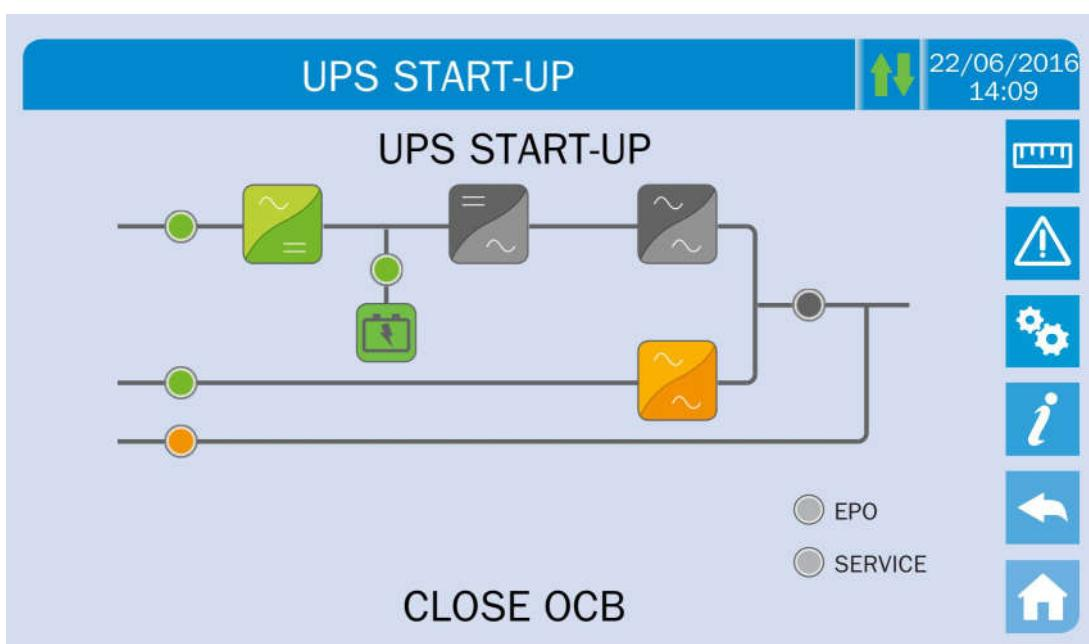
Illustration 20 – Fermeture de l'interrupteur de sortie de l'onduleur
