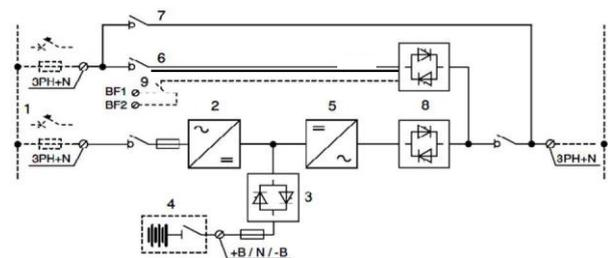
1. Separater Netzeingang für Gleichrichter und Bypass
