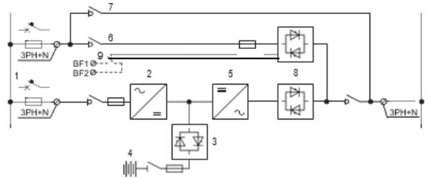
1. INGRESSI SEPARATI PER RADDRIZZATORE E BYPASS RADDRIZZATORE CARICA BATTERIE
